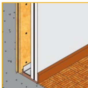
Cloison sèche de distribution en ouvrage neuf
