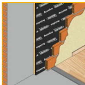
Cloison traditionnelle en rénovation
