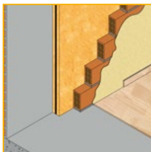
Cloison traditionnelle en réhabilitation
