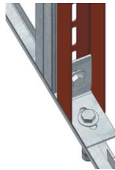
Fig. 3 : Fixation par équerre UA 48 au sol. Gruger le rail F47 pour positionner correctement le montant UA 48
