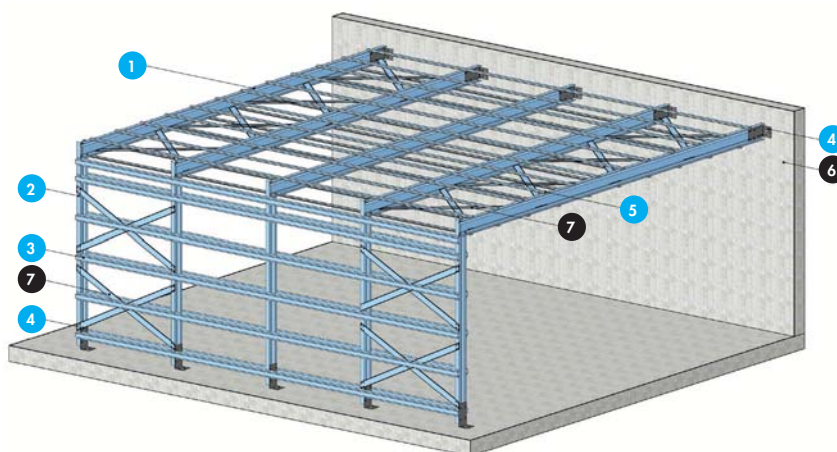
Fig. 4 : Schéma de principe d'un demi-portique
