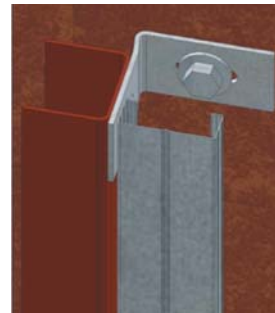
Fig. 2 : Fixation en tête par équerre
