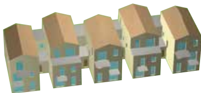
Exemple de bâtiment à faible compacité (étendu)
